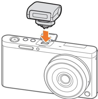
3 Sécurisez le flash en tournant le cadran de fixation du flash dans le sens inverse des aiguilles d'une montre.
