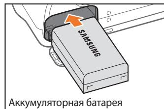
Вставьте аккумуляторную батарею эмблемой Samsung вверх.
