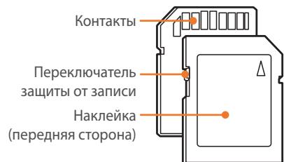
С помощью переключателя защиты от записи на карте SD, SDHC или SDXC можно запретить удаление файлов. Переместите переключатель вниз, чтобы установить защиту карты, или вверх, чтобы снять защиту. Во время фото- и видеосъемки защита должна быть отключена.
