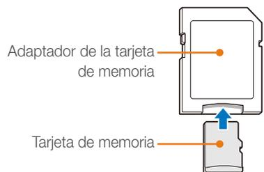
Para utilizar tarjetas de memoria micro con este producto, un PC o un lector de tarjetas de memoria, inserte la tarjeta en un adaptador.
