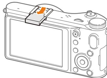
2 Conecte el flash deslizándolo en el montaje.
