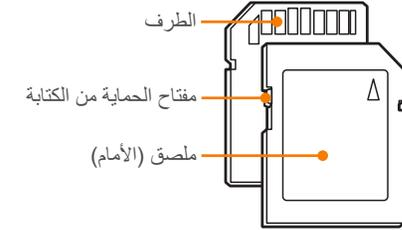
بإمكانك منع حذف الملفات عن طريق استخدام مفتاح الحماية من الكتابة على بطاقة SD أو SDHC، أو SDXC. حرك المفتاح نحو الأسفل للحماية أو نحو الأعلى لإلغاء الحماية. افتح البطاقة عند التقاط الصور وملفات الفيديو.
