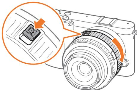
Pour déverrouiller l'objectif, tournez la bague de zoom dans le sens contraire des aiguilles d'une montre jusqu'à ce que vous entendiez le déclic.
