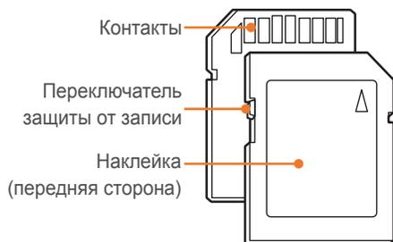
С помощью переключателя защиты от записи на карте SD или SDHC можно запретить удаление файлов. Переместите переключатель вниз, чтобы установить защиту, или вверх, чтобы снять ее. Во время фото- и видеосъемки защита должна быть отключена.
