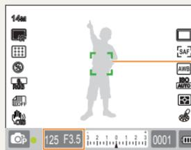
Muestra el valor de la velocidad y la apertura del obturador que se está ajustando
