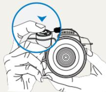
Чтобы убедиться в том, что фокус настроен правильно, слегка нажмите на кнопку спуска затвора. При неполном нажатии кнопки спуска затвора, фокусировка и экспозиция будут настроены автоматически.
